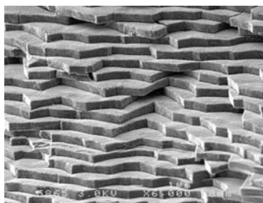
Coupe de nacre d'une coquille d'huître en MEB © Romain MALLET, SCIAM
